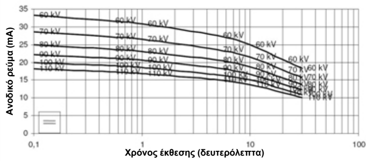
Εικόνα 12 Εκπομπές νήματος της λυχνίας ακτίνων Χ: OPX 105
